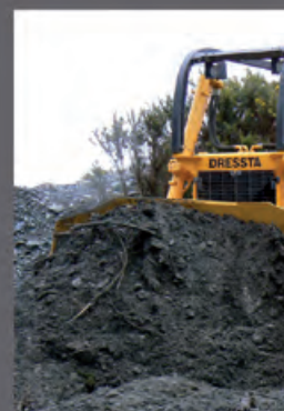
Lemiesze wklęsły, półwklęsły i skośny są stosowane do prac ziemnych. Lemiesz skośny jest stosowany do wyrównywania
