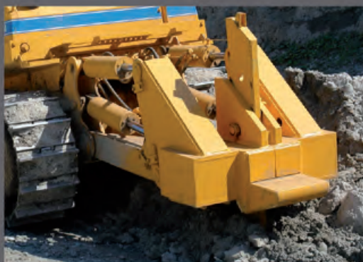
Zrywaki jedno i wielozębny są wyposażone w hydrauliczny przechył zęba zrywaka
